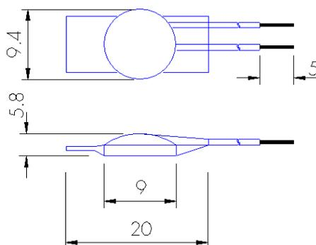
**Bild 1:** Abmessungen
